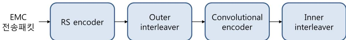
(그림 6-7) 재난방송 송신채널을 위한 채널부호화 및 인터리빙 방식
