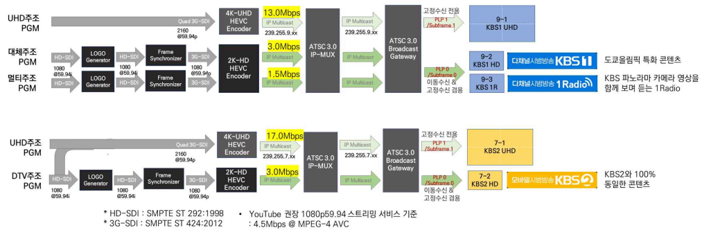
(그림 5-26) KBS1, KBS2 혁신서비스를 위한 송출 시스템 상세 구성도
