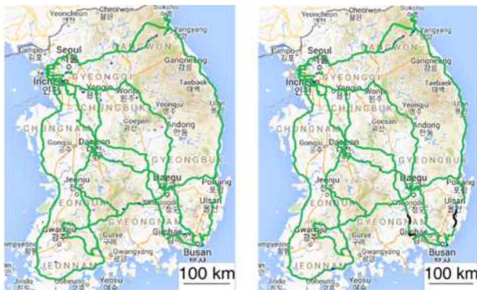
(그림 5-44) B-RTK(좌)와 VRS(우)의 이동 측위 결과
