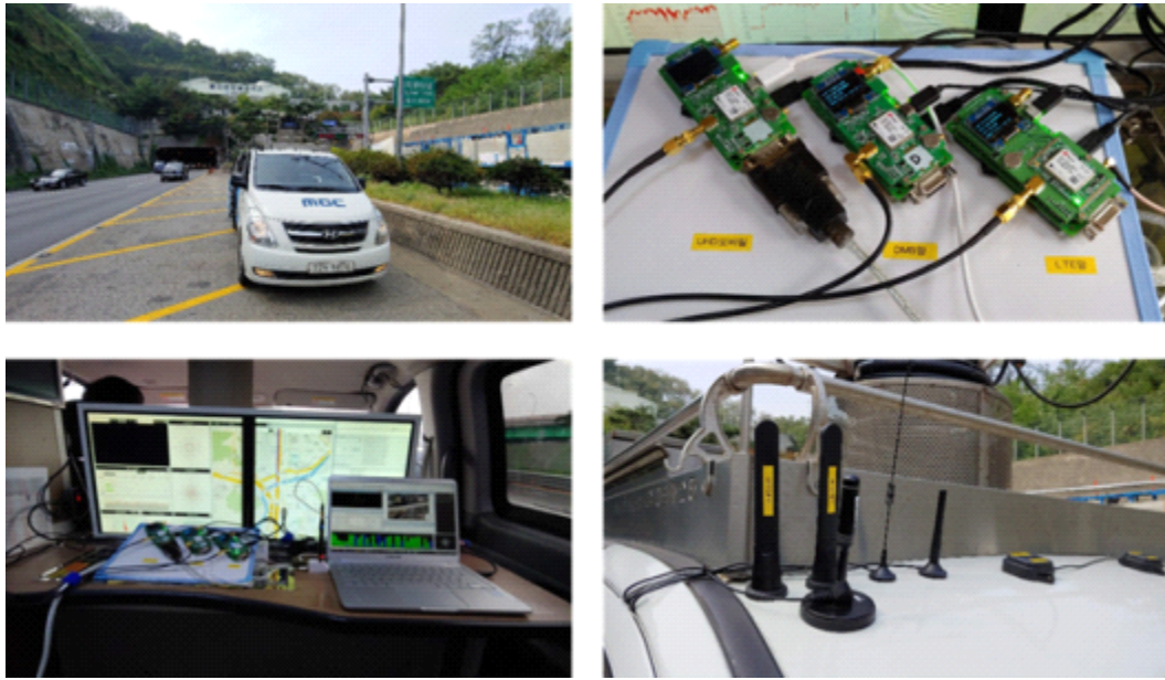
<그림 12> UHD모바일 망을 활용한 RTK 보정신호 전송 실험
