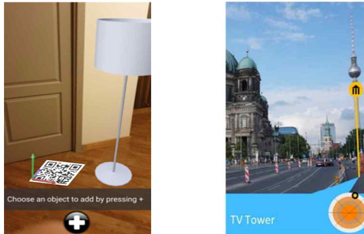
(그림 7-38) World Anchor 예(좌:Mark기반, 우:GNSS기반)
